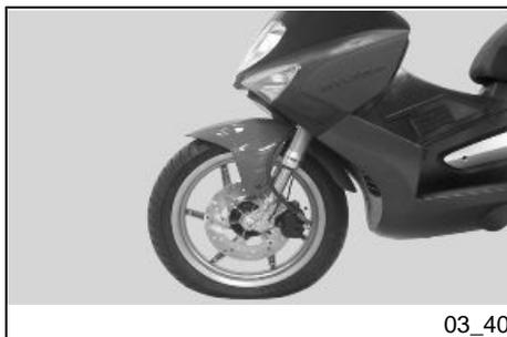
Das Fahrzeug ist mit schlauchlosen Reifen ausgerüstet (Tubeless). Anders als bei einem Reifen mit Schlauch entweicht die Luft bei einem Loch im Reifen aus dem schlauchlosen Reifen wesentlich langsamer. Dies bedeutet eine größere Fahrsicherheit. Im Notfall kann, bei einem langsamen Entweichen der Luft, auch ein "REIFEN-REPARATURSPRAY" benutzt werden. Für eine dauerhafte Reparatur oder einen Reifenwechsel empfehlen wir Ihnen sich an eine **Piaggio-Gilera-Vertragswerkstatt** zu wenden.
