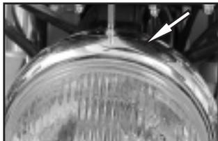
1. Entfernen Sie die Schraube am Gehäuse. Halten Sie den Scheinwerferkörper fest und entfernen Sie ihn.
