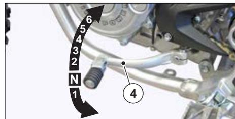
Immer um je einen Gang herunterschalten; das gleichzeitige Herunterschalten mehrerer Gänge kann zur Überschreitung der zulässigen Höchstdrehzahl führen. Vor und beim Herunterschalten muss auch die Geschwindigkeit verringert werden. Dazu den Gasgriff auslassen, um ein Überdrehen der Drehzahl zu vermeiden.
