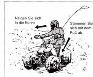
Nehmen Sie genügend Gas weg bevor Sie eine Kurve durchfahren. Zu schnelles einfahren zieht das Risiko eines Sturzes mit sich. Verlagern Sie Ihr Körpergewicht in die Kurve und stützen Sie den kurvenäußeren Fuß auf der Fußablage ab.
