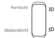
**Fernlicht/Abblendlicht:** Drücken Sie oben auf den Schalter, um das Fernlicht einzuschalten; drücken Sie den Schalter nach unten, um das Abblendlicht umzuschalten.
