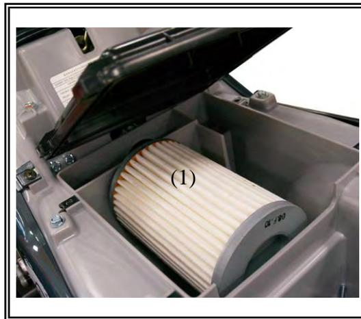
5. Reinigen Sie das Filterelement mit einer speziellen Reinigungslösung. Spülen Sie das Element mit warmen Wasser ab und lassen Sie es trocknen.
