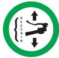
Bringen Sie das Fahrzeug zum vollständigen Stillstand bevor sie in den Rückwärtsgang schalten da es sonst zu Schäden am Getriebe führen kann.
