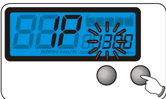
Le nombre d'impulsion à régler est de 03 , appuyer sur le bouton ADJ pour sélectionner le digit souhaité (dans ce cas le deuxième).
