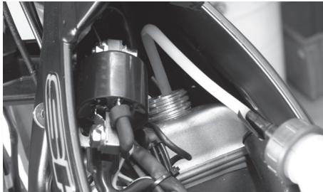
Rellene el depósito del sistema de refrigeración si es necesario. Tipo de líquido refrigerante recomendado: MINERVA.
