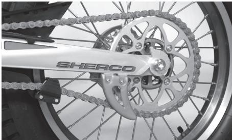
Con la moto en posición de descanso y sin carga en la suspensión trasera, la cadena debe tener un movimiento libre de 3 cm. Justo en la parte donde actúa el tensor. El enganche de la cadena debe ir posicionado en el sentido contrario al del giro de la rueda.
