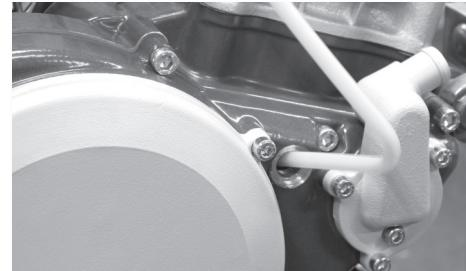
El motor dispone de dos orificios, uno en cada cárter derecho al lado de la bomba de agua, para garantizar la correcta distribución del aceite.
