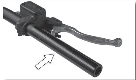
Es importante mantener el manillar limpio y engrasado en el punto donde va anclado el puño del gas. De no ser así, puede ocurrir un funcionamiento irregular a causa de roces.
