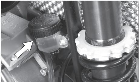
Para acceder al depósito de líquido de freno del grupo trasero es necesario quitar primero la parte posterior de la carrocería guardabarros y la caja del filtro. El depósito esta ubicado detrás de la caja del filtro de aire, por lo que es recomendable que en cada revisión del filtro, se realice también la comprobación del nivel de líquido.
