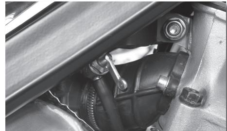
**ATENCIÓN:** para la correcta colocación del depósito de gasolina, deberá primero instalar el tubo, abrir el grifo de la gasolina y a continuación colocar el depósito en su posición.
