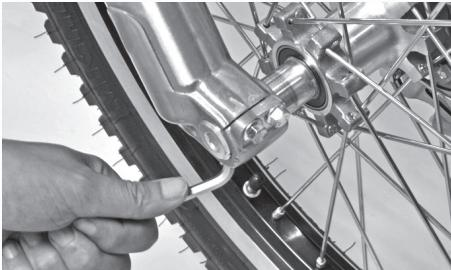
Para vaciar de aceite de la suspensión afloje, con una llave Allen nº 8, el tornillo que se encuentra en la parte inferior de la botella. Una vez aflojado, presione la suspensión varias veces para el completo vaciado del aceite. Es muy importante que el aceite relleno sea de la viscosidad y en la cantidad adecuada tal y como se indica en la tabla de regulaciones.
