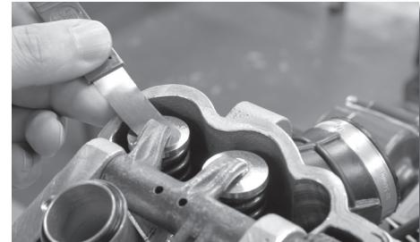
Pasadas las primeras 5 horas de funcionamiento se deberá revisar el ajuste de válvulas. Utilice un juego de galgas para la correcta comprobación.
