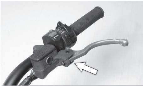
Mantenga el anclaje de las manetas siempre limpio y bien lubricado para obtener la máxima suavidad. El depósito de líquido de la bomba dispone, a cada lado (freno y embrague), de una pequeña mirilla para comprobar el nivel del líquido.
