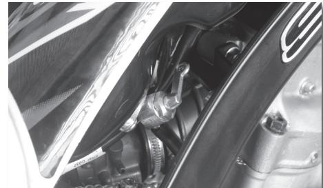
**A continuación, cierre el grifo de gasolina y retire el tubo y el depósito.**
