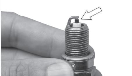
El estado de la bujía nos permitirá conocer si el motor realiza una correcta combustión. Es por ello que este elemento debe estar siempre en perfectas condiciones y con una separación entre el electrodo y el arco de 0,80mm.
