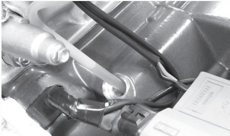
El otro orificio de llenado está ubicado en el cárter izquierdo. Utilice igualmente un embudo para facilitar el llenado de aceite. Cantidad en el cárter izquierdo: 100cl.
