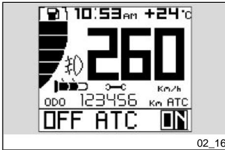
Wird der Wählschalter mit einem kurzen Druck nach rechts gestellt, wird das System eingeschaltet.
