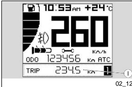
Die Anzeige der Teilstrecken-Werte erfolgt am unteren Display-Bereich (E). Es kann folgendes angezeigt werden:
