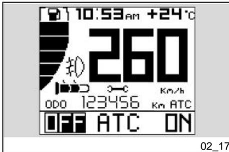
Zum Ausschalten des Systems den Wählschalter mit kurzem Druck solange nach links stellen, bis der "OFF" angezeigt wird.
