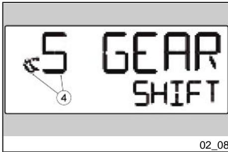
(\*) Der Gang wird aus dem Verhältnis zwischen Fahrzeuggeschwindigkeit und Motordrehzahl berechnet. Mit betätigtem Kupplungshebel oder stillstehendem Fahrzeug kann die Berechnung nicht durchgeführt werden und es wird "-" angezeigt.
