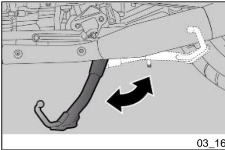
Im Seitenständer ist ein Sicherheitsschalter integriert, der dazu dient den Betrieb des Motors bei eingeschaltetem Gang und heruntergeklapptem Seitenständer zu verhindern bzw. zu unterbrechen.
