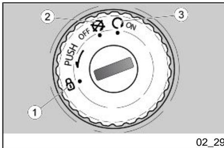
**LOCK (1):** Die Lenkung ist blockiert. Es ist nicht möglich den Motor zu starten und die Beleuchtung einzuschalten. Der Schlüssel kann abgezogen werden
