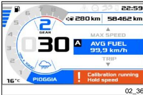
Zum Kalibrieren des Systems MGCT (Moto Guzzi Control Traction) ca. 10 Sekunden lang auf einem ebenen geraden Straßenabschnitt im zweiten Gang bei einer Geschwindigkeit von 30 +/- 2 km/h (18,64 +/- 1,24 mph) fahren, bis auf dem Digitaldisplay die Meldung "Calibration running Hold speed" angezeigt wird.
