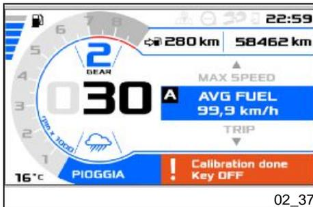
Wenn die Kalibrierung korrekt abgeschlossen wird, wird die Meldung "Calibration done Key OFF" angezeigt.
