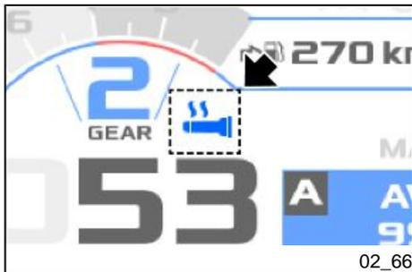
Es gibt 3 Wärmestärken und diese werden nacheinander von Stufe 1 (minimale Intensität) bis Stufe 3 (maximale Intensität) bei jedem kurzen Druck auf den Schalter aktiviert. Nach der Stufe 3 wird mit einem weiteren kurzen Druck auf den Schalter die Funktion ausgeschaltet.
