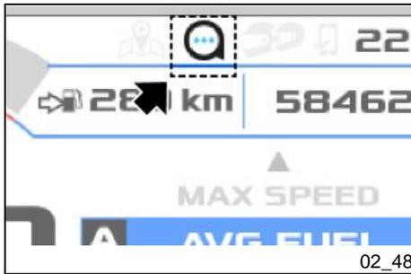
Wenn das MGMP-System an das Smartphone angeschlossen ist über Bluetooth Low Energy, ist das entsprechende Symbol auf dem digitalen Display gekennzeichnet.
