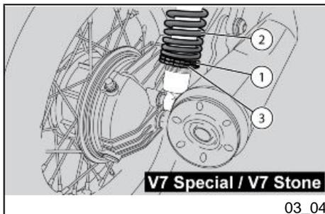
Für die Einstellung ist der Stoßdämpfer mit einem Gewinding (1) zur Einstellung der Federvorspannung (2) und einem Spannring (3) ausgestattet.
