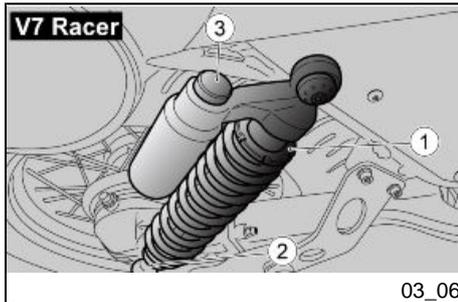
Für die Einstellung sind die Stoßdämpfer einem Gewinding (1) zur Einstellung der Federvorspannung, mit einem Gewinding (2) zur Einstellung der hydraulischen Dämpfung in Zugstufe und einem Knauf zur Einstellung der hydraulischen Dämpfung in Druckstufe (3) ausgestattet.
