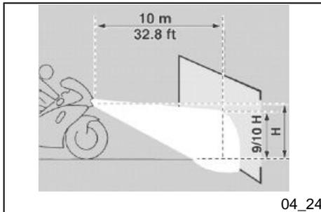
Zur schnellen Kontrolle der richtigen Ausrichtung des Scheinwerferstrahls:
