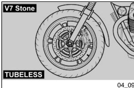
BEI EINEM ZU NIEDRIGEN REIFENDRUCK WERDEN DIE REIFENWÄNDE STÄRKER BELASTET, DER REIFEN KÖNNTE AUF DER FELGE RUTSCHEN ODER SICH ABLÖSEN, WAS ZUM VERLUST DER FAHRZEUGKONTROLLE FÜHREN WÜRDÉ.
