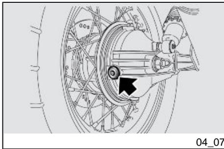
Den Kardanölstand regelmäßig kontrollieren und den Ölwechsel entsprechend der Angaben aus der Tabelle für das Wartungsprogramm vornehmen.
