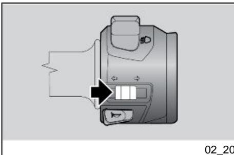
Wenn nach links abgebogen werden soll, den Blinkerswitch nach links stellen; Wenn nach rechts abgebogen werden soll, den Blinkerswitch nach rechts stellen. Zum Ausschalten der Blinker auf den Switch drücken.
