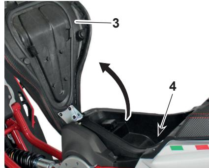
**HINWEIS:** Nach dem Öffnen des Fachs unter dem Sattel ist es möglich, den Schlüssel aus dem Schloss zu ziehen.
