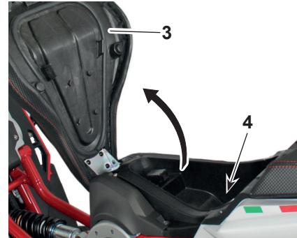
**NOTA:** Dopo l'apertura del vano sottosella è possibile rimuovere la chiave dalla serratura.
