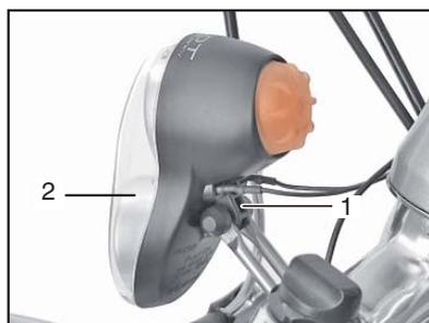
Der Scheinwerfer muss so nach vorn geneigt sein, dass die Mitte des Lichtkegels nach 5 m nur noch halb so hoch liegt, wie beim Austritt aus dem Scheinwerfer.
