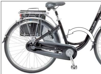
Pedal für Hinterradbremse mit Rücktrittbremse
