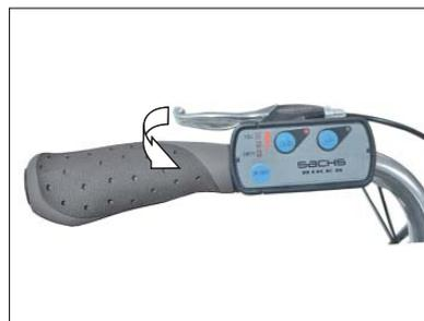
Handbremshebel für Hinterradbremse
