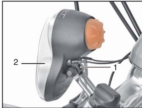
Der Scheinwerfer muss so nach vorn geneigt sein, dass die Mitte des Lichtkegels nach 5 m nur noch halb so hoch liegt, wie beim Austritt aus dem Scheinwerfer. In der Praxis bedeutet dies, dass nur eine Fahrbahnausleuchtung von höchstens 10 m erlaubt ist.
