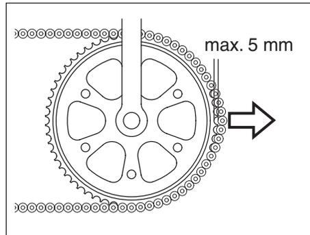
Bei korrekter Kettenspannung darf sich die Kette nicht mehr als 5 mm vom Zahnkranzgrund abheben lassen.
