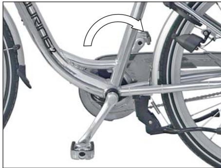
Pedal für Hinterradbremse mit Rücktrittbremse
