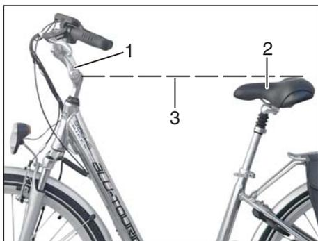
Um ein bequemes, ermüdungsfreies und sicheres Fahren zu ermöglichen ist die Sattel- und Lenkerhöhe der jeweiligen Körpergröße anzupassen.
