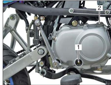
Bei Bedarf Motoröl SAE 15W/40 über die Öffnung der Öleinfüllschraube (2) nachfüllen.
