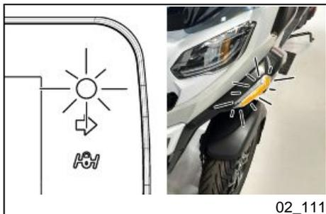
Dreht man den Anlasserschalter danach auf «OFF», um das Fahrzeug abzustellen, blinken die WEGFAHRSPERREN-Kontrolllampe und die Fahrtrichtungsanzeiger gleichzeitig 20 Sekunden lang.
