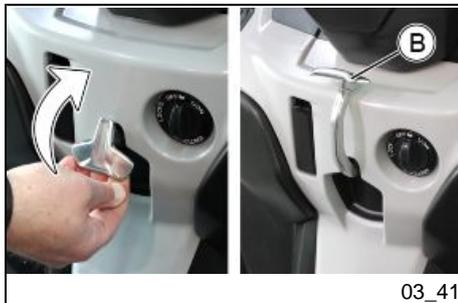
Zur Aktivierung der Feststellbremse muss der Hebel hochgezogen und von der Position «A» in die Position «B» gebracht werden.
