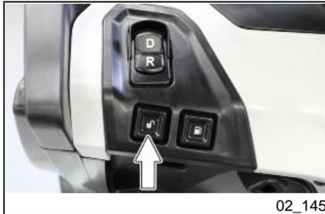
Außerdem kann die Sitzbank auch elektrisch geöffnet werden, indem die entsprechende Taste am Lenker gedrückt wird, wenn sich das Zündschloss in Position «OFF» oder «LOCK» befindet.
