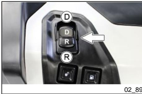
Mit dem Betriebsartenwahlschalter Drive/Rückwärtsgang in Position «R» (Rückwärtsgang) betätigt der Anlasserschalter den Rückwärtsgang. Die Auswahl des Rückwärtsgangs wird durch das Bild der hinteren Kamera auf dem digitalen Display angezeigt.
