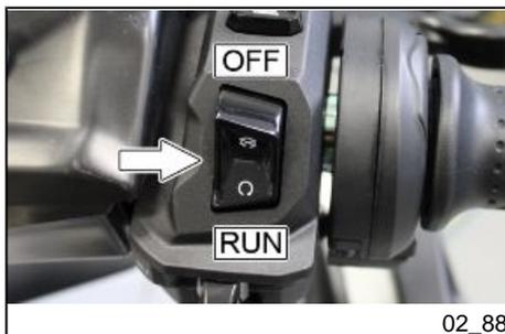
Mit dem Schalter zum Abschalten des Motors in Position "RUN" den Anlasserschalter drücken, um den Motor zu starten, nachdem einer der beiden Bremshebel gezogen wurde.
