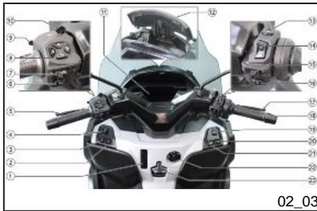
**17 = Bremshebel Hinterradbremse**
