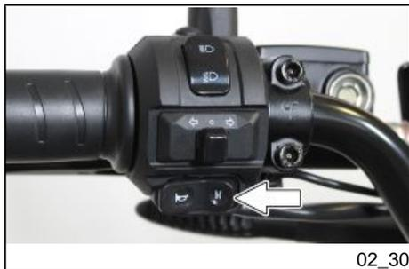
Wenn das Zündschloss in Position «ON» ist, kann die Multifunktionsstafel durchlaufen und die Art des Kilometerzählers ausgewählt werden.
