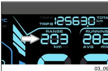
Sobald das Zündschloss in die Position «ON» gedreht wird, wird die verbleibende Kilometerstrecke entsprechend dem gewählten Modus auf dem Digitaldisplay angezeigt.
