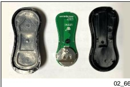
Abschließend die Fernbedienung wieder zusammenbauen, indem man in umgekehrter Reihenfolge zum Zerlegen vorgeht und die Unterseite und die beiden Gehäusenhälften bis zum Einrasten mit den Fingern leicht zusammendrückt.
