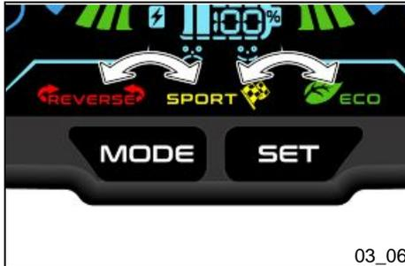
Der Übergang zwischen einem Fahrmodus und dem anderen kann auch bei fahrendem Fahrzeug mit den zuvor beschriebenen Modalitäten erfolgen, mit Ausnahme des Rückwärtsganges, der nützlich ist, um kleine Parkmanöver zu erleichtern.
