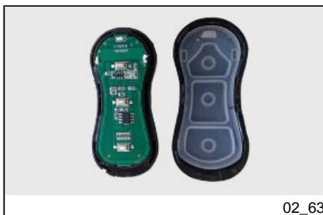
Die beiden Schalenhälften der Fernbedienung trennen, dazu die Spitze eines Schlitzschraubendrehers vollständig durch den seitlichen Schlitz führen.
