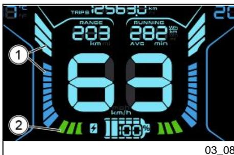
Während der Fahrt wird am Digitaldisplay die Leistungsabgabe und die Energierückgewinnung der Batterie basierend auf dem ausgewählten Fahrmodus angezeigt.
