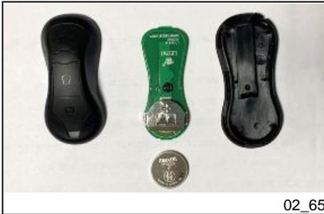
Die neue Batterie mit dem Pluspol (wo das Batteriekürzel steht) in Richtung der Kontaktlamellen einlegen.
